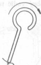
Obr. 329. Směr utahování konce drátu maticí na šroubu
