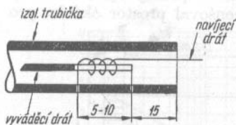
Obr. 91. Provedení vlastního vývodu
