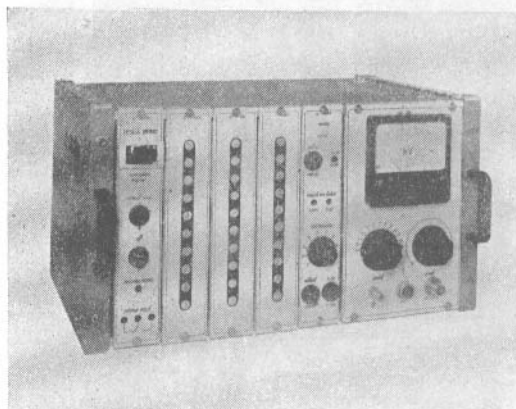
Obr. 274. Panelové provedení se svisle uloženými díly
